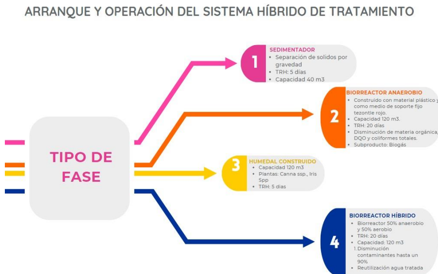
Figura 13. Arranque y operación del sistema híbrido de tratamiento.
